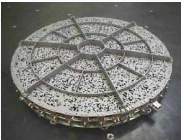
Рис. 10. Фотография кодирующей маски рентгеновского телескопа JEM-X обсерватории ИНТЕГРАЛ.
